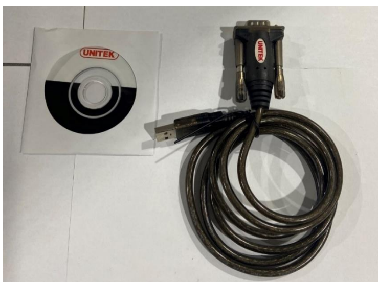
Рисунок 8. Диск с драйвером для кабеля/переходника USB – RS232C и кабель/переходник USB – RS232C
